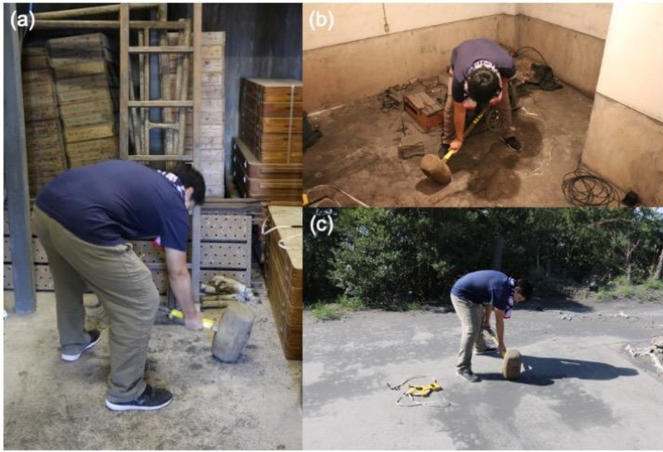
図 40. かけやによる起震作業. (a) 地点 A, (b)地点 B, (c)地点 C.
